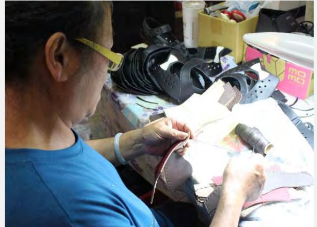
圖二：以其中一手之拇指及食指捏持針體刺穿過皮革，連接處須以針線來回縫合數十次。
